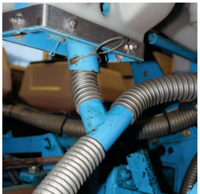
Dank der Luftunterstützung bleibt der Dünger nicht mehr stecken. Vor allem am Hang ist die Betriebssicherheit wesentlich besser.
