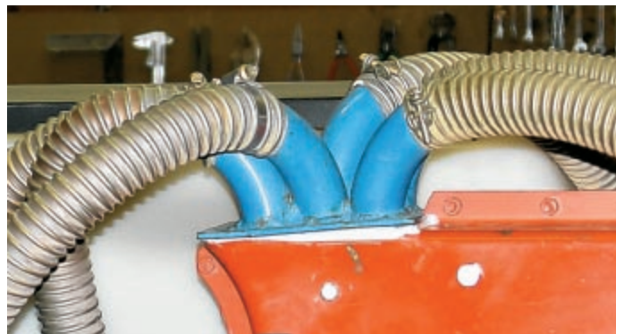
Der gesamte Querschnitt der Abluftleitungen muss gross genug sein um die Vakuumleistung nicht zu behindern.
