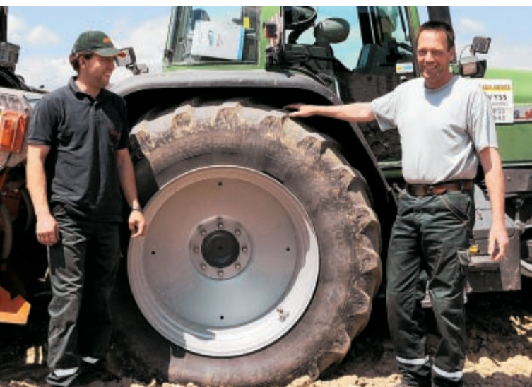
Beat Wyss (rechts im Bild) und sein Fahrer zeigen, dass der XeoBib auch nach über 5000 Betriebsstunden noch einiges an Profilstollen aufweist.
