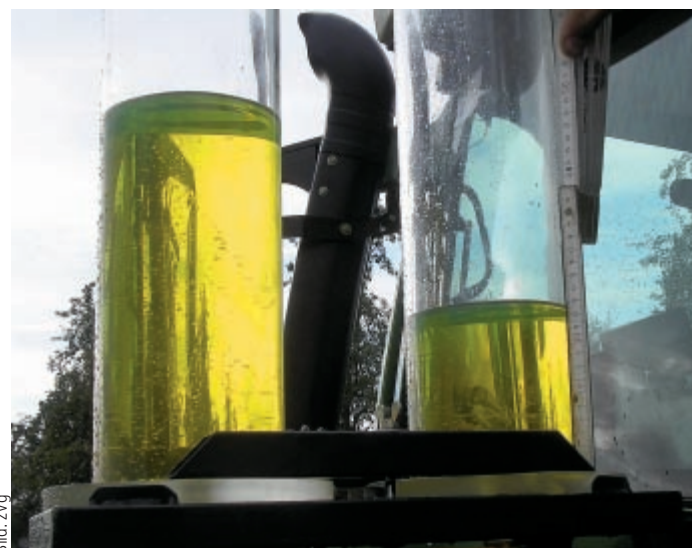
In Feldvorführungen demonstriert Michelin, wie viel weniger Treibstoff das Abfahren eines identischen Parcours mit reduziertem Luftdruck verbraucht.
