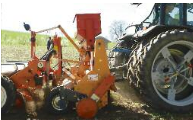
Fräse und Sämaschine sind kompakt zusammengebaut. Da auf eine Packerwalze verzichtet wurde, wird die Fräse über Stützräder geführt.
