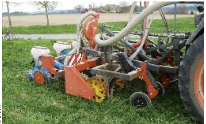
Die Bodenwerkzeuge zur streifenförmigen Lockerung stammen von Horsch. Den Rahmen baute Beat Kilchenmann selber.
