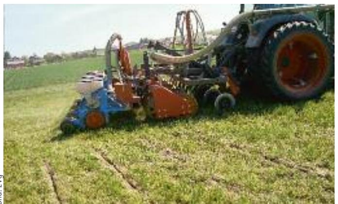
Ein Zinken lockert den Boden 15 bis 20 Zentimeter tief. Das Saatgut wird in der Feinerde unter dem Wurzelteppich abgelegt.
