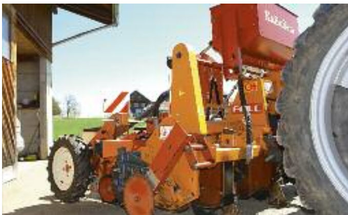
An der 2,5 Meter breiten Bodenfräse wurden Fräskästen eingebaut und die Messerträger neu positioniert und Grubberzinken montiert.
